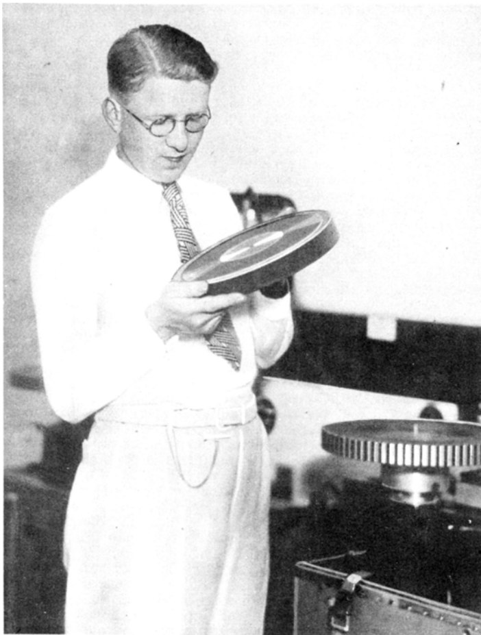
Ist sie gut geraten? Kritische Prüfung einer Wachsaufnahme. Es gehört große Erfahrung dazu, bei der Betrachtung eines Aufnahmewachses feine Fehler zu erkennen. (Werkbild: Telefunken)
